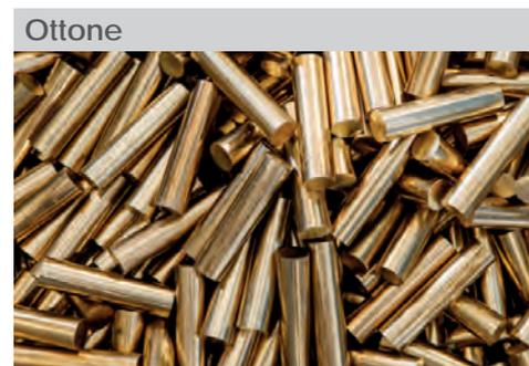
L'ottone è una lega composta da rame e zinco. Data la sua duttilità, si presta a diverse lavorazioni come piegatura, bombatura e forgiatura. Può essere saldato con argento e sottoposto a trattamenti di burattatura, sgrossatura o lucidatura. FIXO trasforma e riutilizza lo sfrido da stampaggio tramite un fornitore certificato per percentuali tra il 70% e il 90%; mentre M&N utilizza ottone da fonti riciclate per percentuali intorno al 50%.
