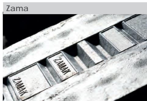
La zama è una lega metallica composta da zinco e piccole percentuali di alluminio, rame e magnesio. È resistente agli urti, alla corrosione ed è estremamente duttile.
